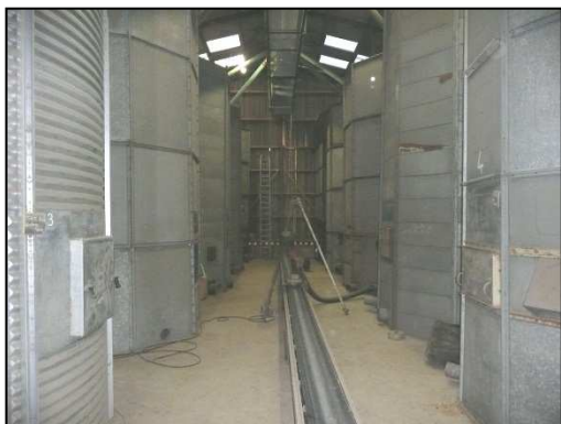
Différentes cellules ventilées à fond plat avec vis et tapis de reprise
